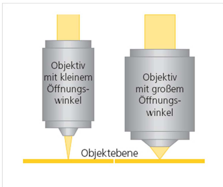
Abbildung 12: Beziehung zwischen Objektiv-Öffnungswinkel und Lichteinfall. Die Abbildung zeigt schematisch Objektive mit einem kleinen und einem großen Öffnungswinkel. Der größere Öffnungswinkel erlaubt einen größeren Lichteinfall und somit ein besseres Auflösungsvermögen (Carl Zeiss Microscopy GmbH).
